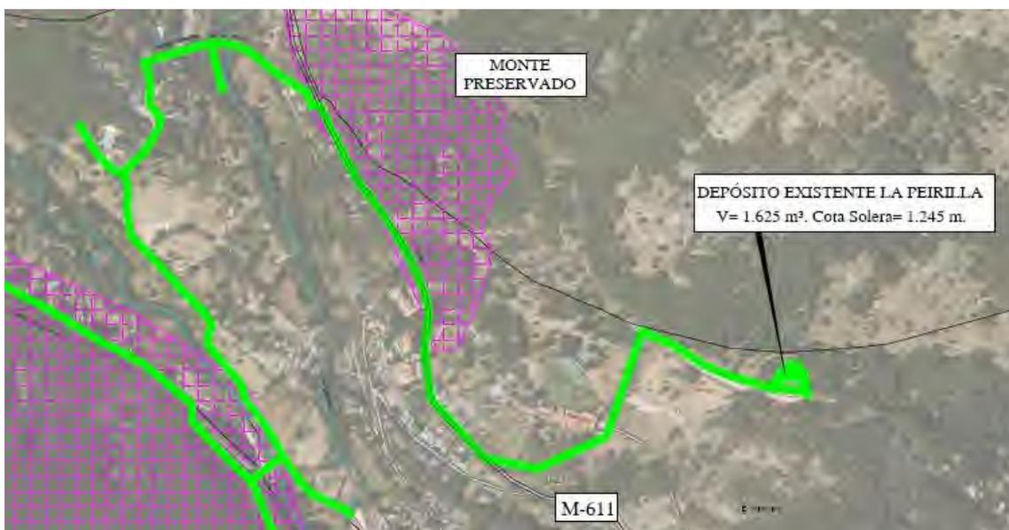
Figura 3.1.2.- Detalle de variante trazado de conducciones por M-611 (Fuente: Elaboración propia)
